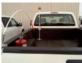
SZ-120 Whip de sécurité avec ressort pour camionnette
