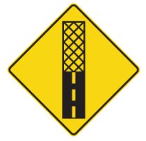
DC-340 Changement de l'état d'une chaussée 450 x 450 mm
