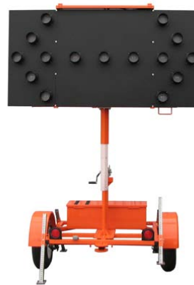
SZ-108 Remorque flèche avec panneau solaire
